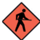
TRABAJOS EN LA BANQUINA
