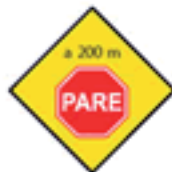
PROXIMIDAD DE SEÑAL RESTRICTIVA (pare)
